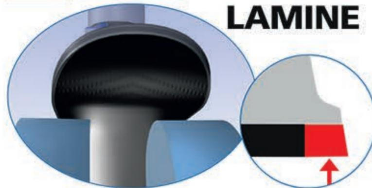
Viene affilata la parte inferiore della lamina (Tuning).
